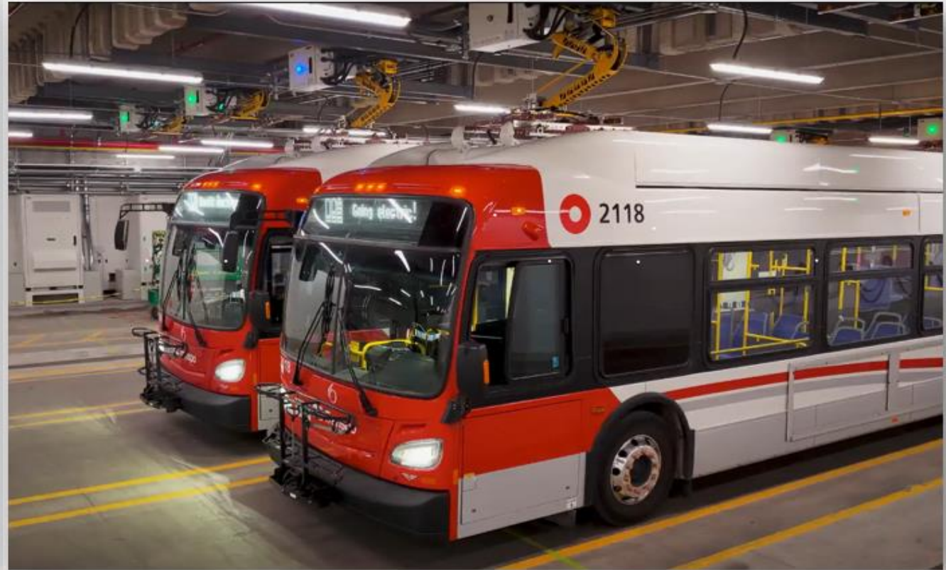
Autobus électriques sous les pantographes pour les recharger
