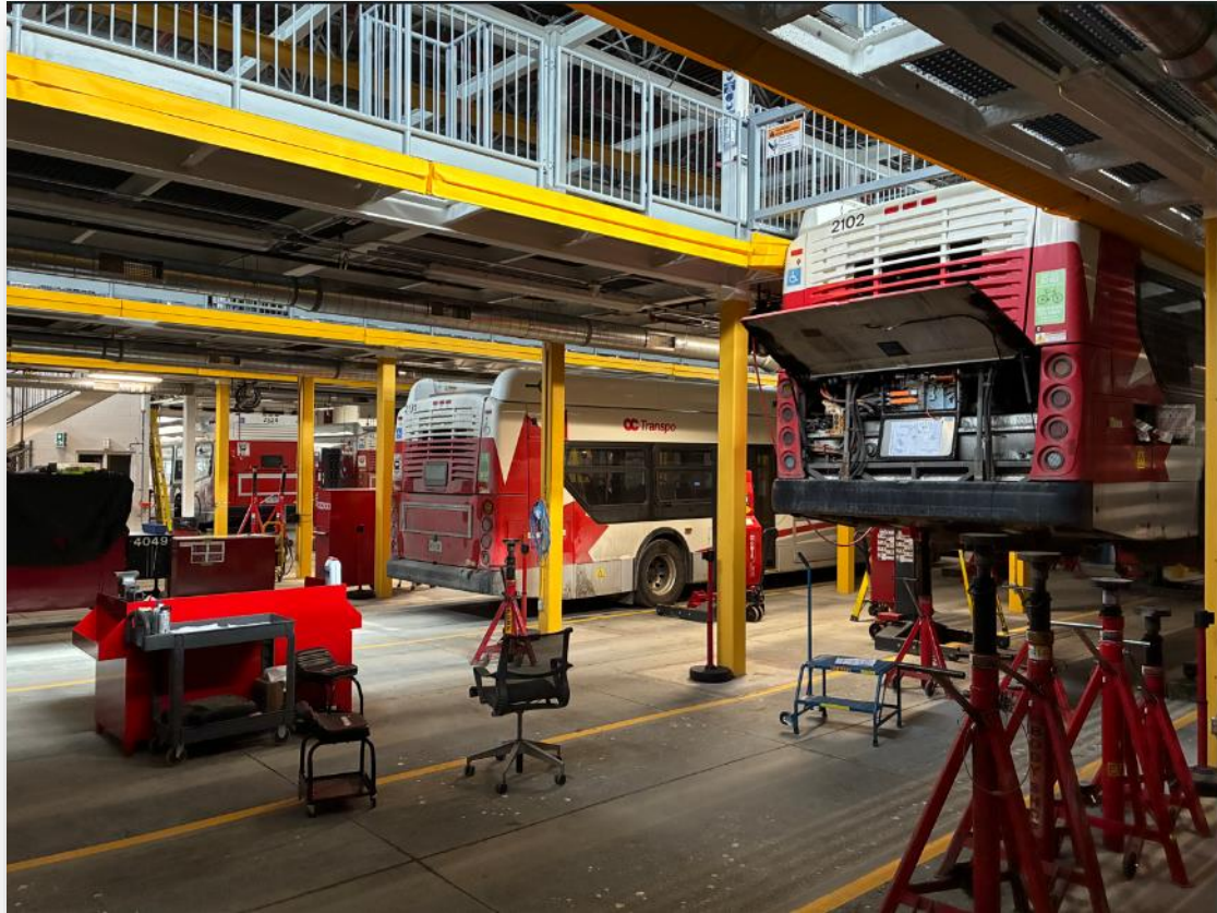
Autobus électriques en train d'être entretenus dans les aires d'entretien à haute tension
