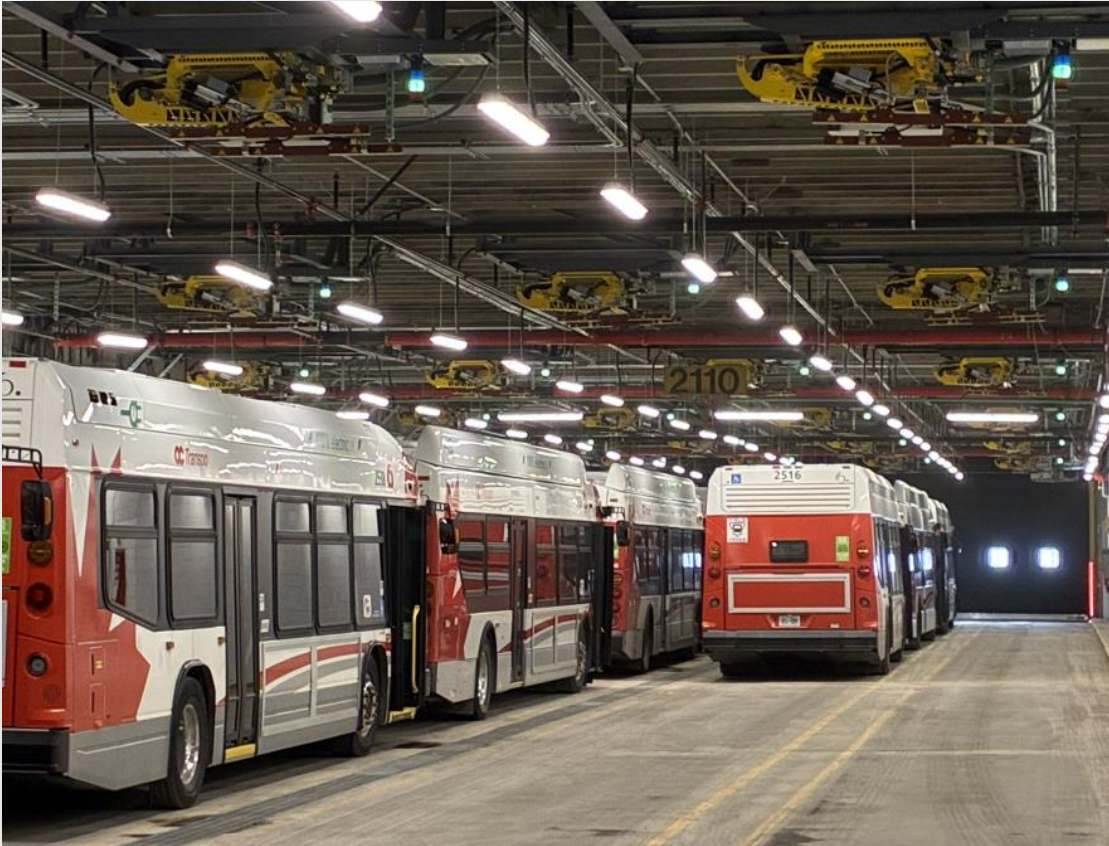
Autobus électriques sous les pantographes pour les recharger
